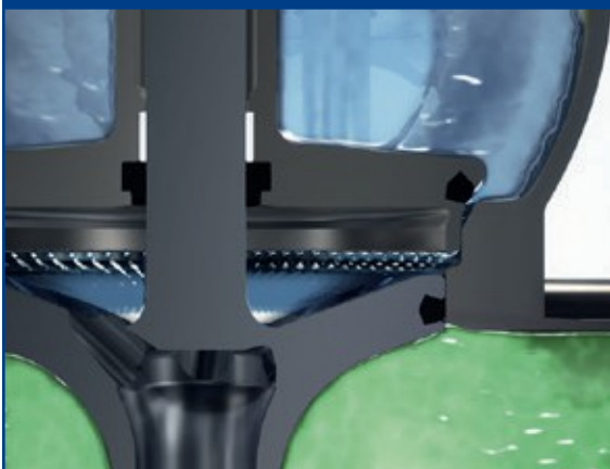
Image 2. Nettoyage de l'élévateur de siège
